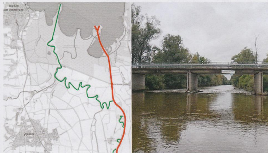
Abb. 9: Durch die Verlegung der Ammermündung wurden rund ein Dutzend Mäander (grüner Verlauf) vom Fluss abgetrennt und durch einen geradlinigen Fließkanal (roter Verlauf) ersetzt. Den Ammerseeforellen sind dadurch unzählige strukturell vielfältige Laichhabitate genommen worden. Bis 1925 wurde der Hauptzufluss des Sees dann auf seiner gesamten Länge reguliert und verbaut. Den Seeforellen war damit die Wanderung zu den flussaufwärtsliegenden Laichgründen nicht mehr möglich. Zumindest die Durchgängigkeit der Ammer ist zwischenzeitlich wieder weitgehend hergestellt. Wenngleich die Verlegung des Mündungsbereichs und die Strukturarmut des Flusses weiterhin Bestand haben
